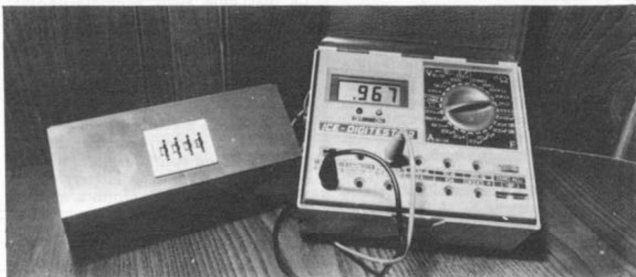
Il controllo dei valori resistivi con tester digitale
